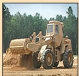
**MgM Rotar:** Extra stark gepanzertes Minenentferner. Der Rotar verfügt über eine große Siebtrommel, mit der Minen aller Arten ausgesiebt und anschließend durch manuelle Minenräumung entfernt werden können.
