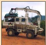
**MgM Mulcher:** Vegetationsentferner. Der Mulcher bereitet das manuelle Entfernen von Minen in überwuchertem Gelände vor, in dem er Auslösedrähte, Sträucher, Büsche und ähnliches entfernt. So erleichtert der Mulcher die Arbeit der Minensucher.
