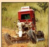
**MgM Grader:** Der Grader ist eine modifizierte, stark gepanzerte Straßenbaumaschine. Er durchkämmt den obersten Straßenbelag und setzt im Boden gelöste Gerüche von Sprengstoff frei. Dies erleichtert den Hunden die Suche nach Landminen. Nach erfolgreicher Arbeit begradigt der Grader die Straße und macht sie wieder befahrbar.
